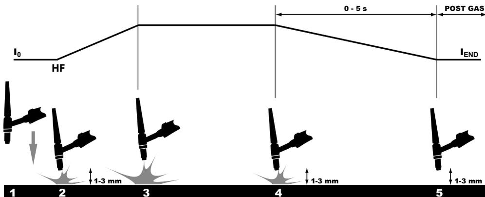
Obr. 1 - průběh svařovacího procesu u TIG HF
