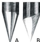
**Obrázek 5A** - jemné a rovnoměrné broušení elektrody v podélném směru - trvanlivost až 17 hodin
