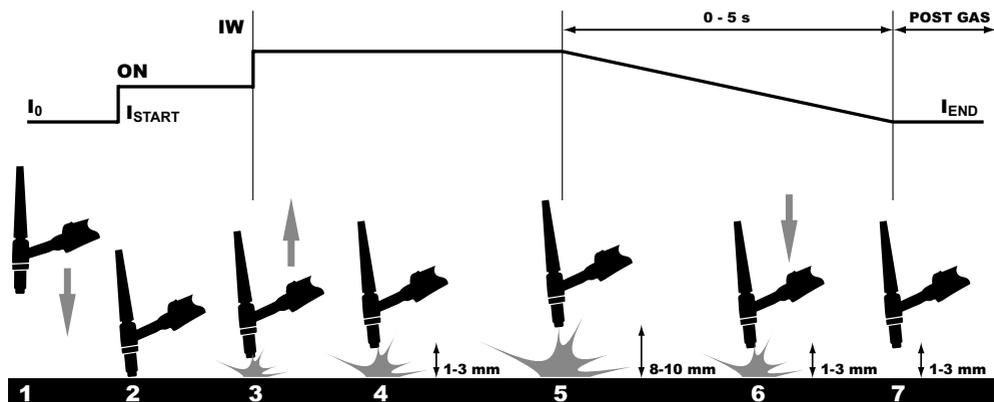
Obr. 2 - průběh svařovacího procesu u TIG LA
