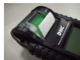
C. Vložte z přihrádky malou délku papír z přihrádky a stiskněte průhledný kryt, aby se zavřel.
