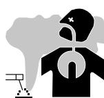
Při plazmatickém řezání dochází k vývinu spalin příp. toxicických výparů, které mohou způsobit nedostatek kyslíku ve vdechovaném vzduchu. Proto vždy zajistěte přívod dostatečného množství čerstvého vzduchu a instalujte odsávání (nebo použijte schválený dýchací přístroj). Řezání provádějte pouze v rádně větraných halách, ve volném prostoru nebo v uzavřených prostorách s intenzivním odsáváním, v souladu s aktuálně platnými bezpečnostními normami.
