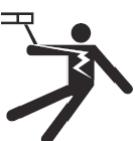
A berendezés kizárolag csak védőföldeléssel ellátott elektromos hálózaton használható! Használja a táblázatban javasolt méretű biztosítékot.
